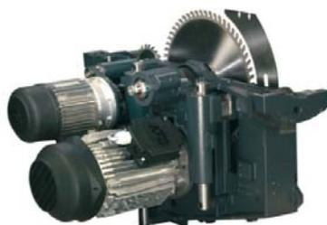
フェルダラーの 700 シリーズは一体成型の鋳物を使用しており堅牢な作りですが、使い勝手の良さと効率性を先進技術の採用により追求しています。例えば、注油作業を含めて、メンテナンス・フリーのため作業時間をもロスなく効率的に使うことが出来ます。丸鋸の最大切断高さは104mm（φ315mm の鋸刃を使用時）、19.5mm までのダドカッターフランジ取付可能。
