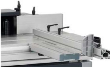
工具を使用せず、短時間で増設できる延長テーブルは加工効率を上げるために多くのユーザに採用されています。
