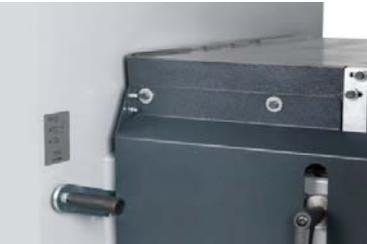
レバー操作だけでギアスピードを変更。簡単に加工材の送り速度を変えられます。
