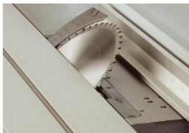
鋸刃傾斜角度調整 90° ~45°
