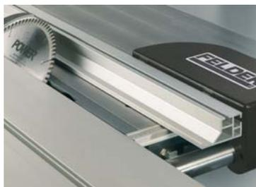
細くて薄い材料の傾斜切断の時はリップフェンスを倒して鋸刃に当たらないようにすることが出来ます。
