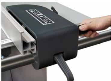
リップ定規は簡単且つ滑らかに調整が可能で、固定クランプなどで片手でも簡単に移動・調整可能。
