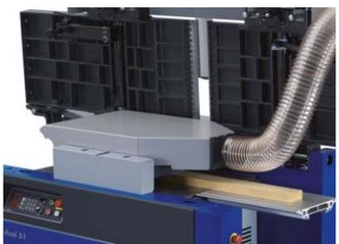
シンプルで迅速に、手押し鉋から自動鉋へ段取り換え可能
