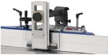
ピンポイント精度、操作が簡単、非常に短い準備時間は最高位の標準規格で保証されます：便利な電動式スピンドルフェンス設定、リセット機能付きの測定値の正確な読み取りが可能なLED-ディスプレイ、取り外し可能な面取り用フェンスガイド、-10～+35mmまで調整可能、径250mmまでの刃物装着可能、モルダーフェンスを、モルダーテーブルから退避させることができます。セントレックスモルダーガード、モルダーフェンスとテーブルの下、2か所から集塵可能。
