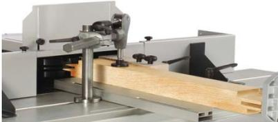
Format-4の軸傾斜スピンドルモルダーは、ほぞ取りと溝付けテーブルは標準装備です。(写真の偏心クランプはオプション)
